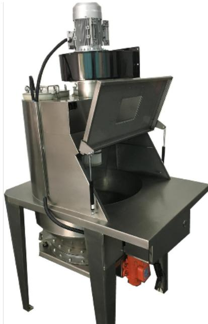
真空粉末吸料机三大作用1. 真空粉末吸料机用在注塑成型的原料输送，可以自动送料给到注塑机。2. 当注塑机的料桶内缺少料时，会给到真空粉末吸料机信号。3. 真空粉末吸料机利用抽风的原理将塑胶原料输送给到注塑机的料桶内，当料达到一定程度的时候，真空粉末吸料机会停止，等到料不够时再次输送即可。真空粉末吸料机的三大特点：1. 操作简单，维修容易，噪音小，寿命高，有逆转除湿装置。2. LAL—300C|300CE附带空气过滤器。3. 真空粉末吸料机配有日本高速整流马达，重量轻，吸力强，安装方便，适合新料输送。杭州粉末投料站无尘投料站加直排筛的效果好不好，有没有筛分视频参考？
